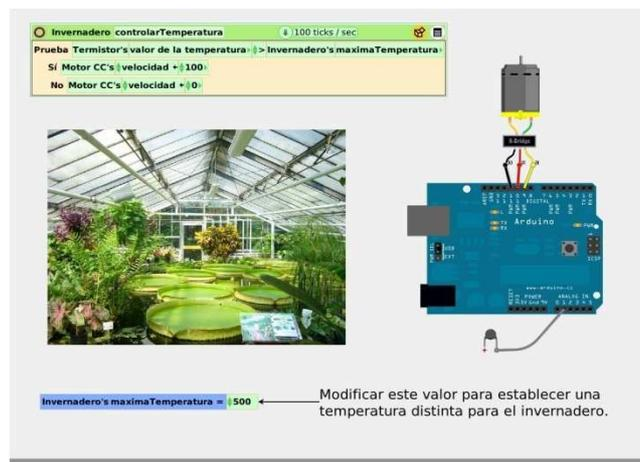
Fig. 7. Ejemplo de modo “compilado”: placa Arduino controlando la temperatura de un invernadero
