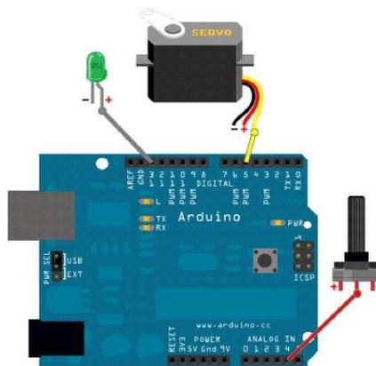
**Fig. 3.** Placa Arduino conectada a un LED, un servo y un potenciómetro
