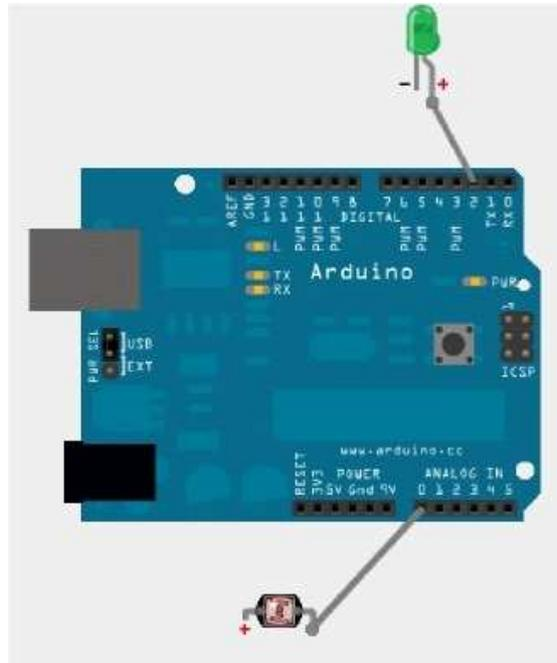
**Fig. 2. Placa Arduino conectada a un LED y a un fotoresistor**
