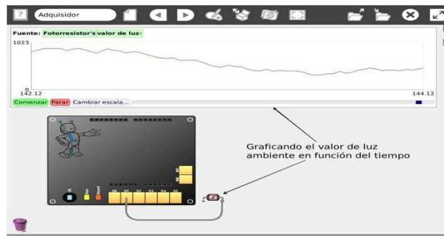
Fig. 6. Ejemplo de modo “directo”: placa DuinoBot como adquisidor de datos
