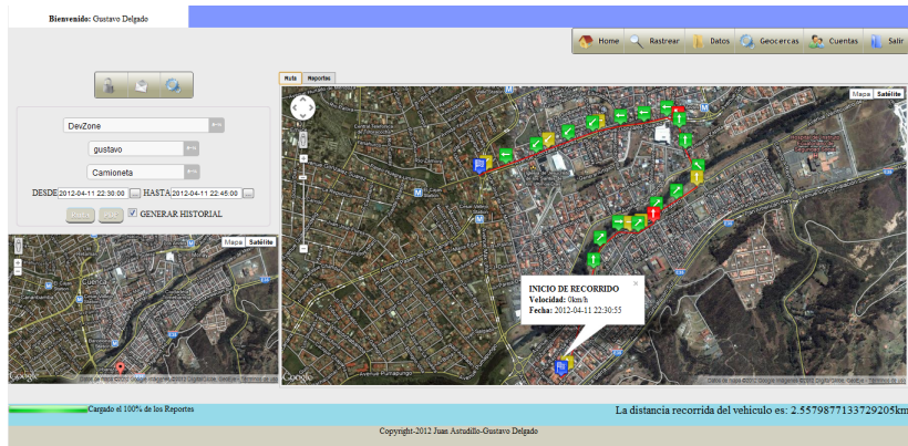
Figura 6. Consulta de la ruta del vehículo, dirección y velocidad en el mapa de Google.
