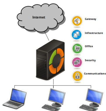
Fig. 1 – Ejemplo de arquitectura de red con Zentyal.
